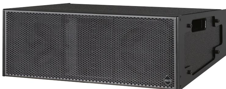
Линейный массив считается собранным, когда несколько модулей закреплены друг с другом и установлены вертикально. Таким образом, может быть связано до 24-х модулей CLA-5K и до 16-ти модулей CLA-8K. Угол наклона каждого модуля регулируется с шагом в 1° в промежутке от 0° до 10°. При включении в состав линейного массива акустических модулей сабвуферов необходимо уменьшать количество модулей CLA-5/8K с учётом закладываемого веса сабвуферов CLA-15/18SK.
