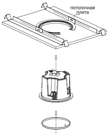
\*потолочное отверстие  $\varnothing$  200~205 мм
