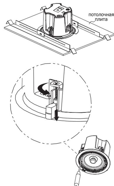
1. Вращайте отверткой по часовой стрелке до плотного прижима к потолочной панели или кронштейну
