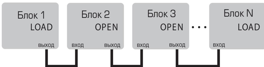
Если DIB-6000 образует или завершает шину управления, как Блок 1 и Блок N на рисунке, то переключатель TERM должен находиться на отметке LOAD.
